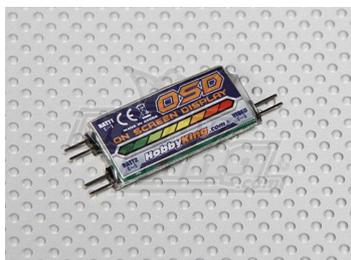
*3 cose da collegare: ingresso video e massa (da collegare alla cam), uscita video e massa (con scritte sovrainposte, da collegare alla Vtx) e batteria che serve all'alimentazione e a far comparire il suo voltaggio in sovraimpressione.*
