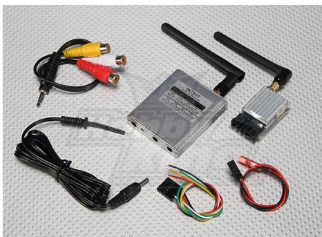
*Il kit FPV di hobbyking, con ricevente (quella grossa) trasmittente, antenne stilo, caverteria varia.*
