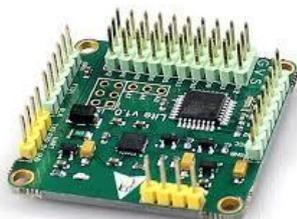
Le versioni base delle schede che supportano MultiWii (CRIUS SE e relativi cloni) hanno un costo assai contenuto (a partire da circa 20 Euro) e garantiscono funzioni di autolivellamento, gestione della quota con sensore barometrico e gestione dell'orientamento del multicottero tramite magnetometro.
