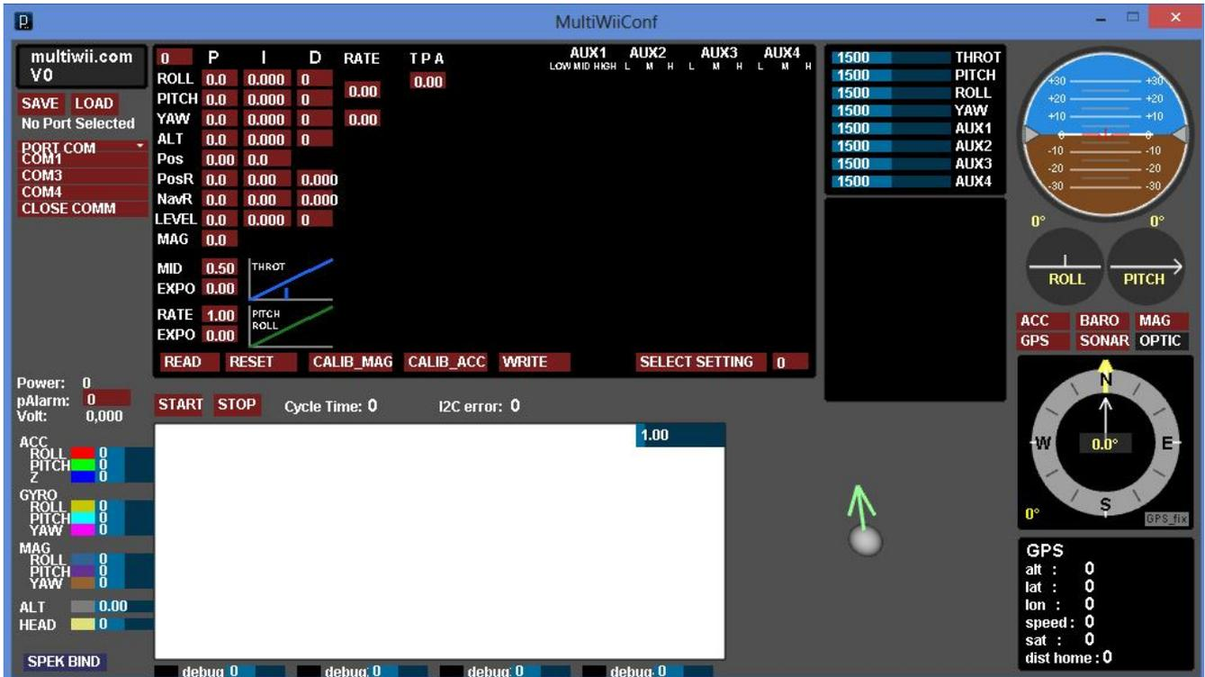
Cliccate sulla porta COM alla quale è connessa la CRIUS e premete il tasto **START**. A questo punto, se il software è stato caricato correttamente e la connessione con il PC ha funzionato, dovrete leggere i parametri della scheda e vedere scorrere il grafico relativo ai suoi sensori (ACC, GYRO, MAG, ALT).
