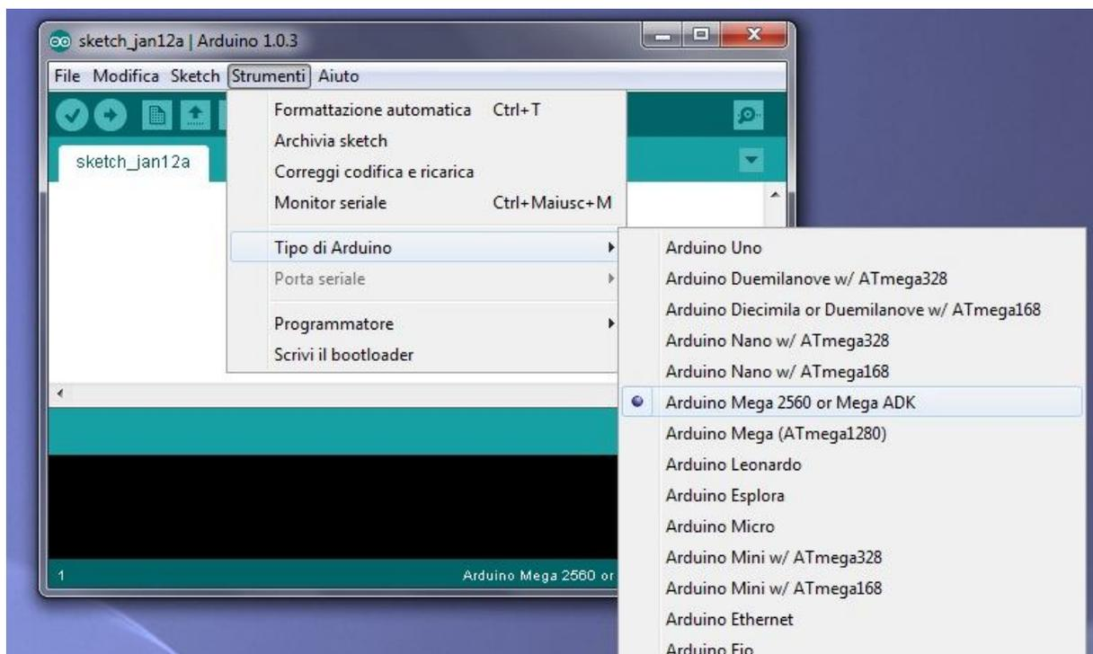
Analogamente verificate che la scheda sia sulla porta seriale riportata in basso a dx (da windows usate pannello di controllo). Altrimenti configuratela manualmente sempre dallo stesso menù "Strumenti".
