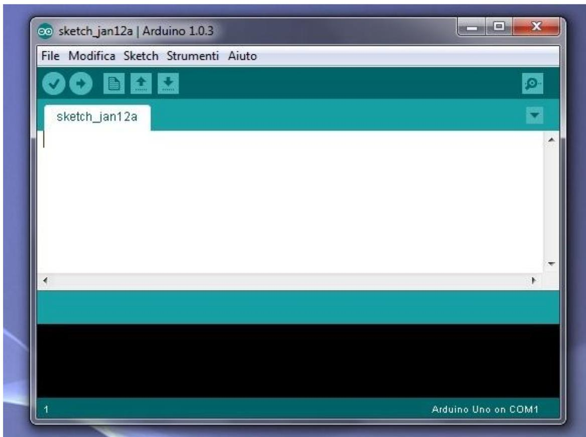
Procedete alla definizione del tipo di Arduino che usa la CRIUS e della porta COM sul quale è installato. Andate nel menù "Strumenti/Tipo di Arduino" e selezionate **Arduino Mega 2560 or Mega ADK**
